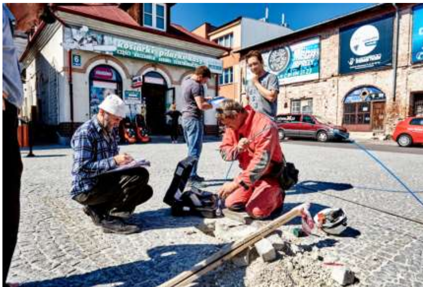
Fot.7. Inwentaryzacja, pomiary, badania i opis pustek objętych i sąsiadujących z planowanym przebiegiem Trasy Turystycznej /fot. P.Drechsler/
