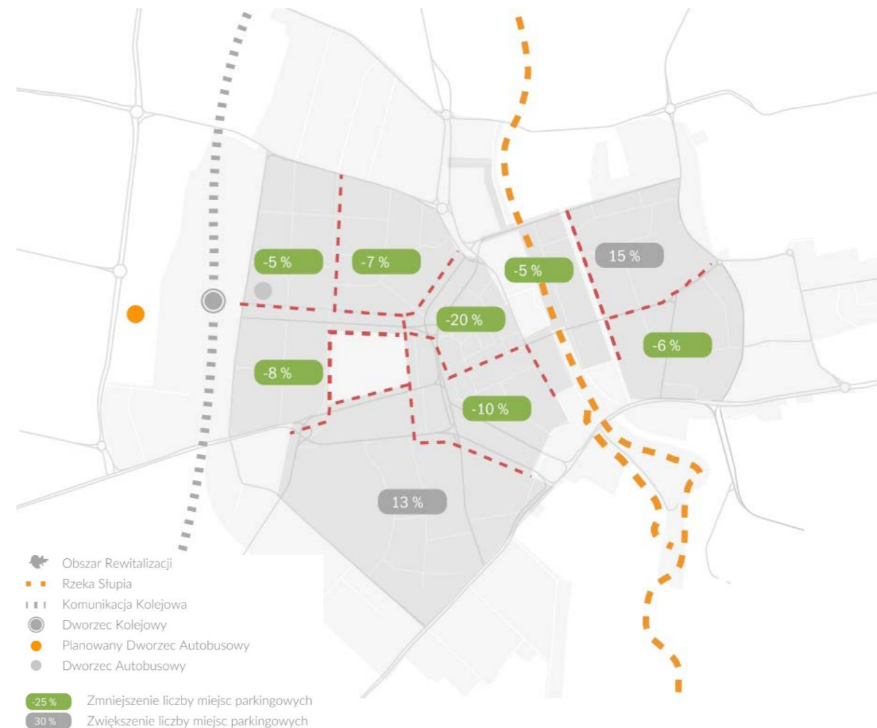
Zmiana ilości miejsc parkingowych po wprowadzeniu ruchu jednokierunkowego i uwolnieniu chodników z funkcji parkingowej
