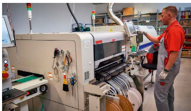
Montaż elementów do przetwornicy / fot. APS Energia
