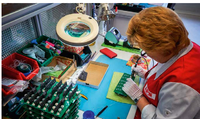
Produkcja elementów do przetwornicy napięciowej / fot. APS Energia
